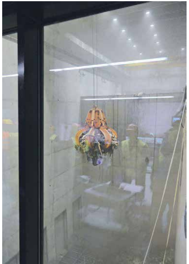
Der Abfall wird mit dem Riesen-Kran der Verbrennung zugeführt.
